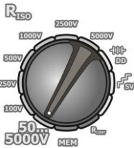
Die eigentliche Messspannung in der Funktion des gemessenen Isolationswiderstandes R_x (für die maximale Messspannung)
